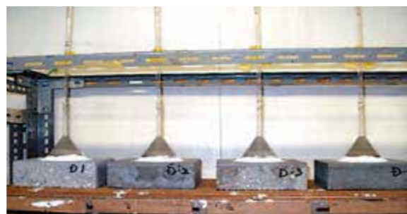
■透水試験B法 JIS A6909 (建築仕上塗材) 透水試験B法により、透水量を測定しました。
